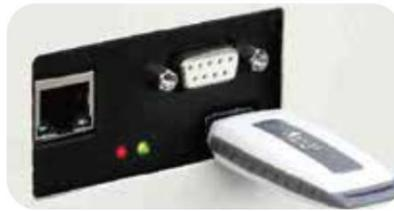
**Armazenamento em disco flash USB.** O armazenamento oportuno de informações de esterilização para garantir que todos os dados possam ser armazenados e rastreados com segurança durante a vida útil do esterilizador. Esta configuração também pode ser atualizada para um sistema de rastreabilidade.
